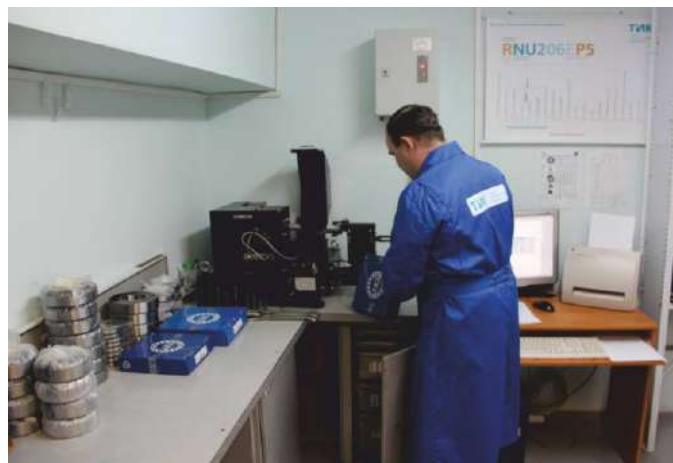
Диагностика подшипников ZKL на стенде вибрационного контроля СВК-А в Лаборатории площадки ТИК-2
