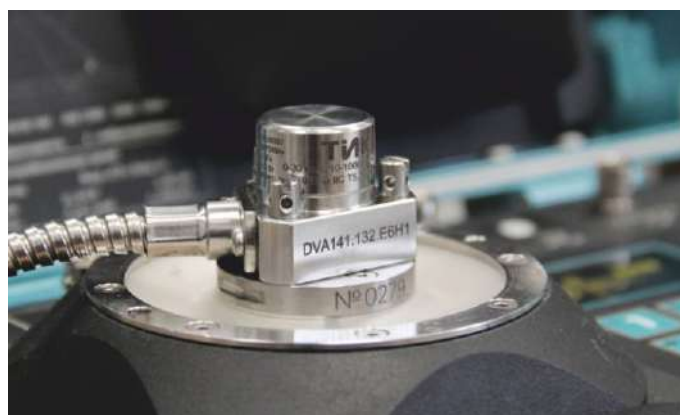
Отдел испытаний оборудования, вибродиагностические испытания датчиков серии DVA
